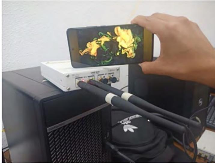
**Fig. 12.** Estudiante haciendo uso de la red celular 5G, realizando el consumo de datos mediante un video de YouTube a través de un radio USRP B210.
