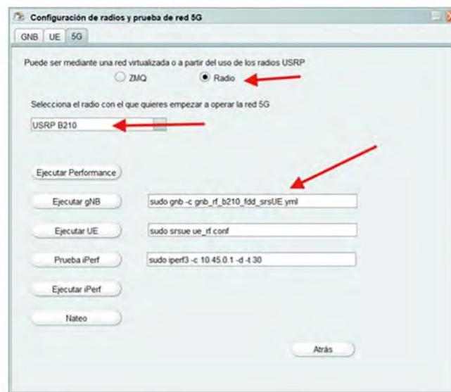
**Fig. 9.** Vista para ejecutar una red celular 5G.
