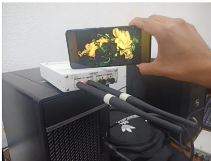
Fig. 12. Estudiante haciendo uso de la red celular 5G, realizando el consumo de datos mediante un video de YouTube a través de un radio USRP B210.
