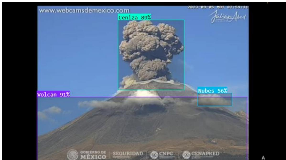
**Fig. 3.** Fotograma de un video de salida con el modelo de Roboflow. En esta imagen, se muestran tres clases y la probabilidad de que la clase reconocida sea correcta, es decir, la computadora tiene una certeza de 89% de reconocer la nube de ceniza de la imagen.
