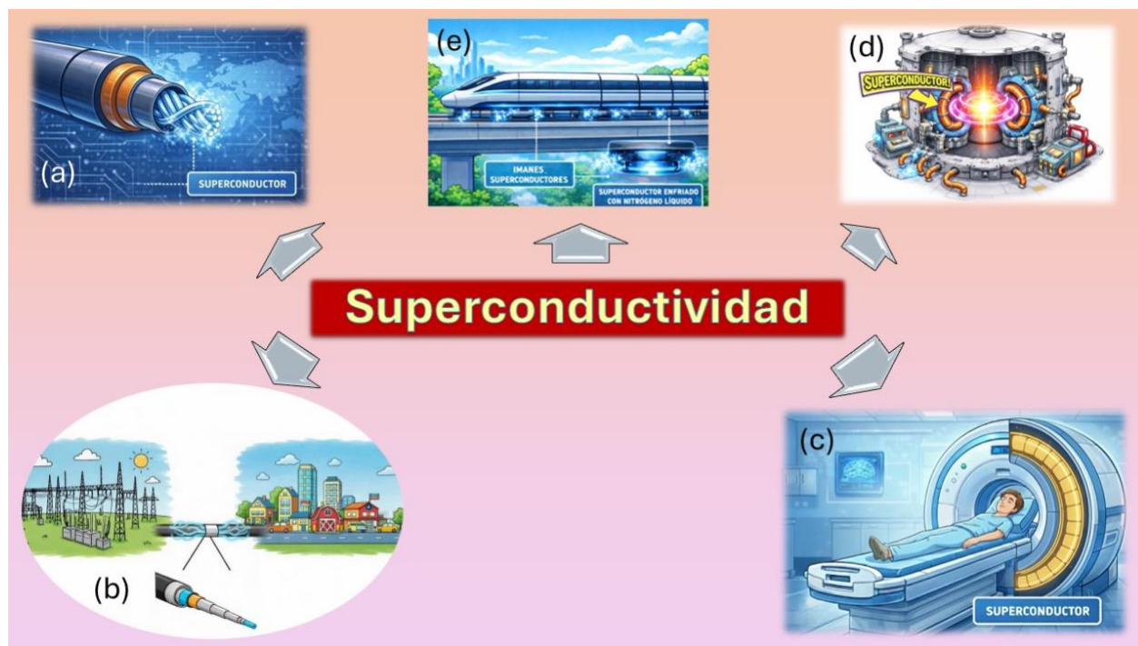
Fig. 2. Aplicaciones de la superconductividad: (a) Cable de multifilamentos trenzados para la generación de campo magnético; (b) Cable de transmisión de potencia con nitrógeno líquido circulando en el centro; (c) Máquina de resonancia magnética; (d) Fusión nuclear controlada; (e) Tren de levitación magnética.
