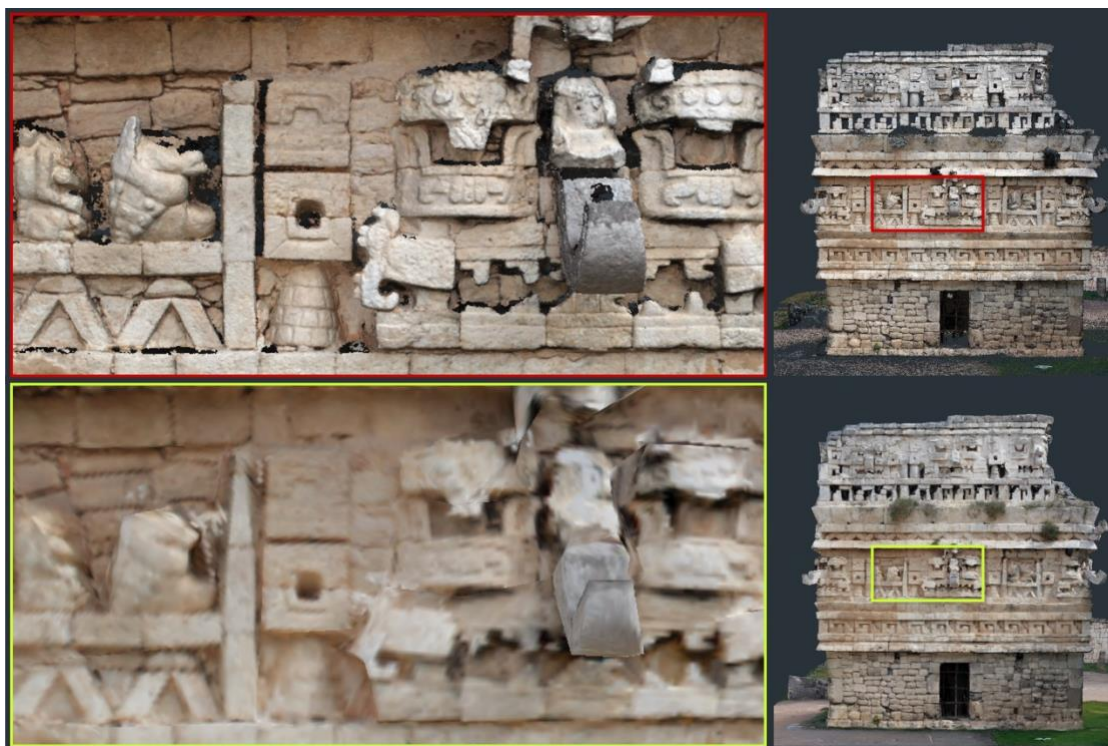
Fig. 1. Nube de puntos filtrada y malla poligonal de La Iglesia. La parte superior muestra la nube depurada y un detalle que evidencia su carácter discreto; la parte inferior presenta la malla generada mediante interpolación y triangulación. Aunque ambas configuraciones pueden percibirse como equivalentes a escala general, el examen detallado revela diferencias derivadas de decisiones computacionales específicas.
