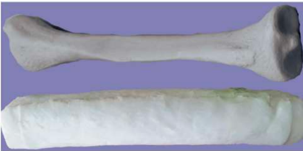
Figura 6. (arriba) hueso tibial sintético ERP #1117-42. (abajo) maniquí de hueso cubierto de PVA.
